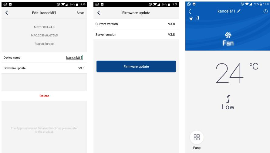
Po klepnutí na ikonku "Func" v levém dolním rohu dostaneme nabídku dodatečných funkcí klimatizace, jako např. zapnutí/vypnutí displeje, časovače, nastavení lamel atp.
